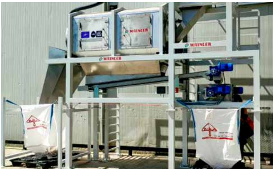
Figur 3: Prototypen, der kan separere membranerne fra æggeskallerne, her en kapacitet på 10 tons i timen
