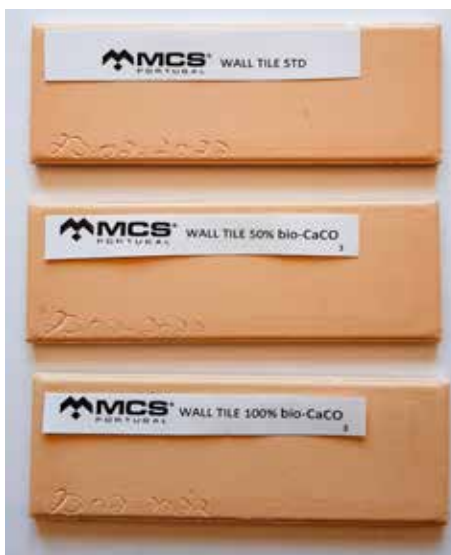
Figur 4: Vægfliser med henholdsvis 0 %, 50 % og 100 % bio-calciumkarbonat fra æggeskaller
