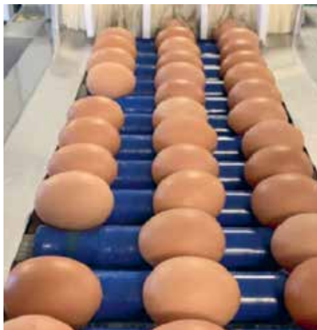
Æggene håndpakkes ved hjælp af en pakkemaskine, der kan håndtere 10.000 æg i timen
