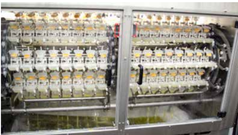
Udslåning af æg sker nu ved meget højere hastigheder og giver højere kvalitet på grund af brugen af kamerasystemer. Foto Vincent Guyonnet
