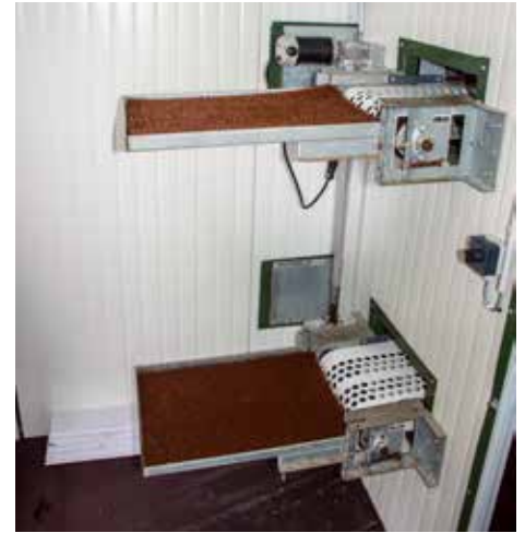
Ægbåndene og pakkearealet, hvor æggene pakkes direkte i bakkerne
