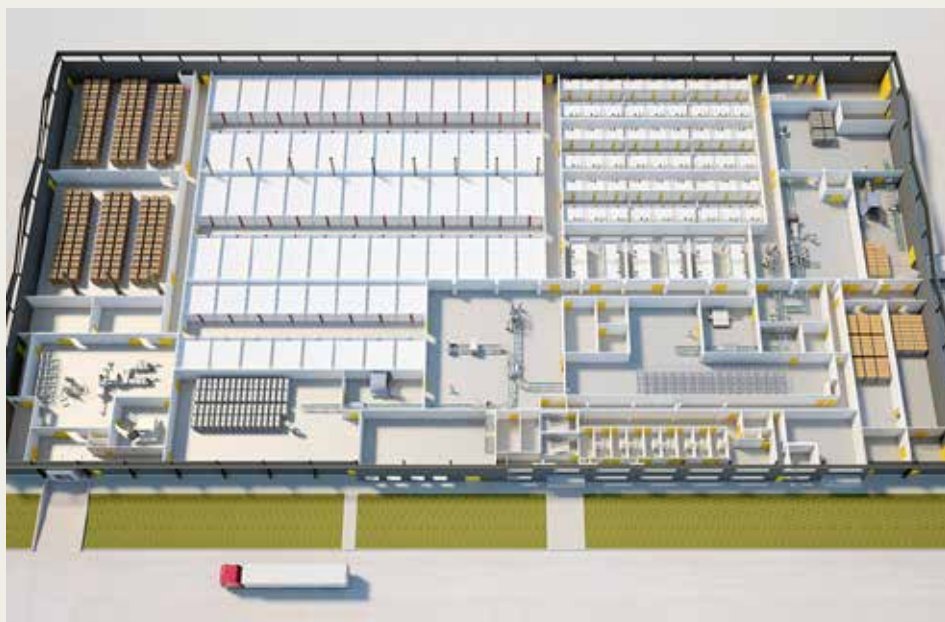
Et skematisk layout af Moy Parks nye rugeri med inventar fra Pas Reform
