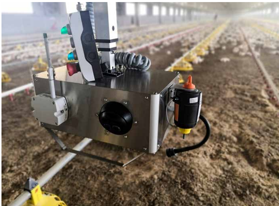
En loftsmonteret robot kan indsamle og spore miljøparametre og identificere potentielle risici for fjerkræs sundhed og velfærd
